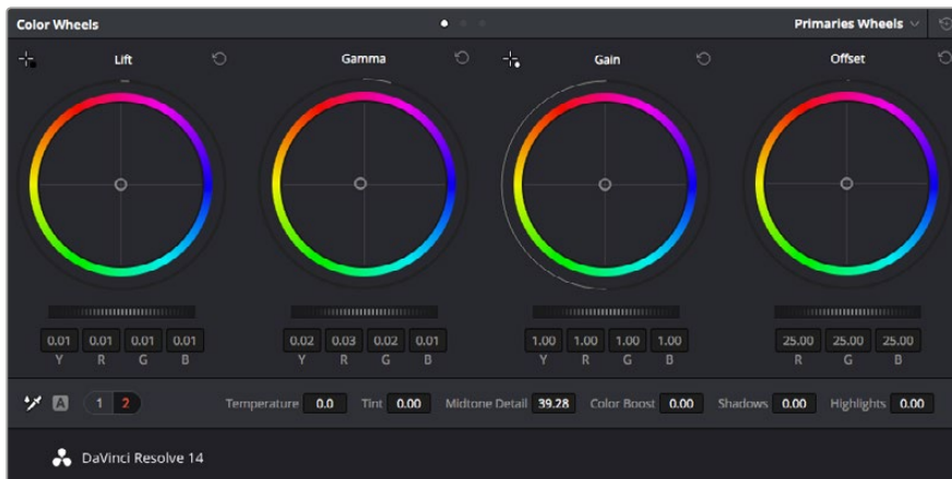
리프트, 감마, 게인, 오프셋을 위한 각각의 컬러휠을 사용하여 클립의 전체 색상과 색상의 균형을 제어할 수 있습니다. 각각의 컬러휠 아래 위치한 다이얼을 앞/뒤로 움직여 조절하면 색상을 균일하게 조절할 수 있습니다.
